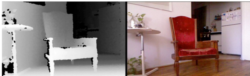
Figura 23: Cámara en profundidad (izquierda) y cámara convencional (derecha) [Borenstein, G. 2012].
